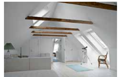
Figuur 3. Dakramen en delen hiervan die op een hoogte van ten minste 1,2 meter zijn gelegen, tellen volledig mee in de bepalingsmethode volgens NEN 2057:2011. Bron: Velux.
